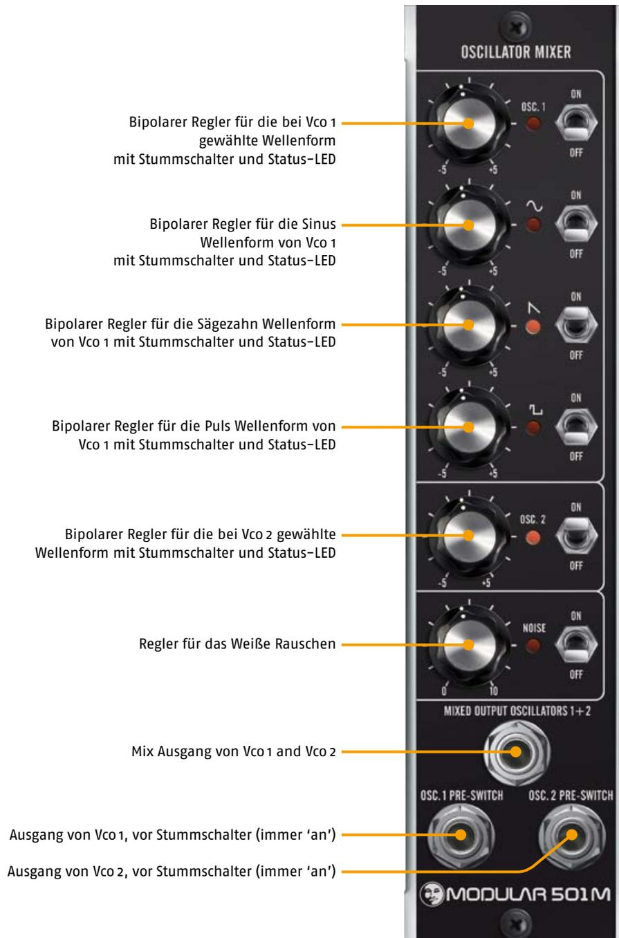
Der M 501 M **OSCILLATOR MIXER** ist ein sechskanaliges Mixermodul, das die angewählten Wave-Ausgänge von Vco 1 und 2, dazu drei individuelle Ausgänge von Vco 1 (Sinus, Sägezahn, Puls und Weißes Rauschen) zusammenmisch.
