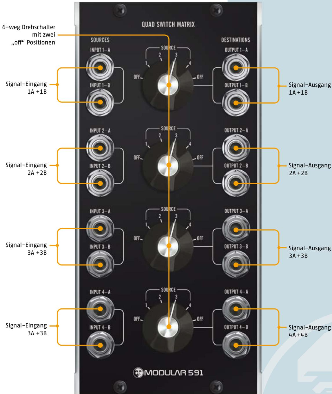
Über vier Drehschalter werden 2 x 4 Signalwege („Source“) paarweise auf vier Ausgangsbuchsen-Paare („Destination“) geroutet.
